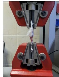
Şekil 2. Testometric(M500-50CT, İngiltere) cihazı ile materyal üzerinde biyomekanik çalışmanın yapılması
