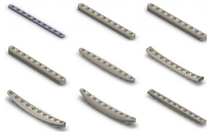
Şekil 2. Metal ve Kompozit Plak Tasarımları
